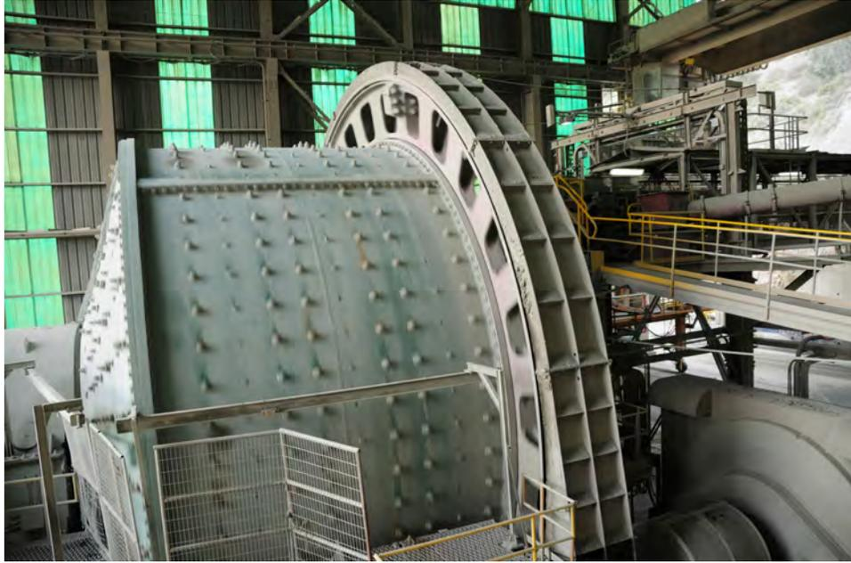
**Figura 10.** Todo motor de inducción que accione una carga grande, como el molino de bolas de la figura, requiere una cantidad importante de potencia reactiva para funcionar. El empleo de la corrección distribuida del factor de potencia evita que la gran demanda de potencia reactiva del motor afecte al factor de potencia de la aplicación industrial.
